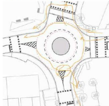
Rotonda en estudi, carril bici perimetral amb cotxes, futur carril central en rambla
